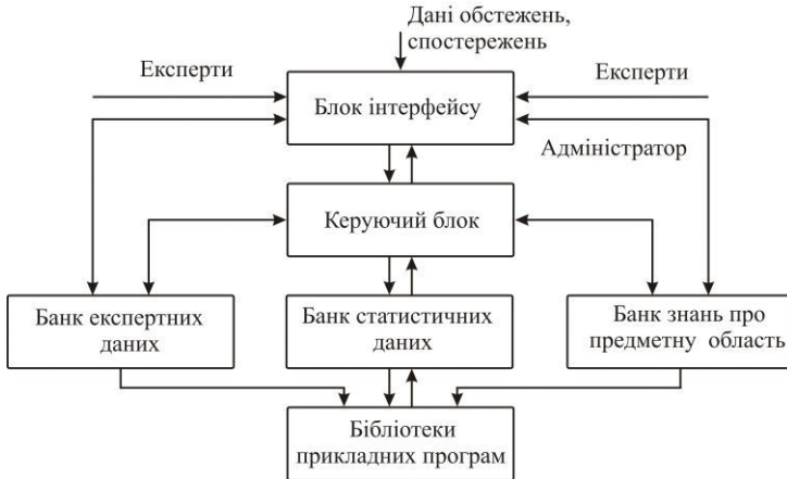
Рис. 1. Загальна схема автоматизованої системи підтримки прийняття рішень АСПО
